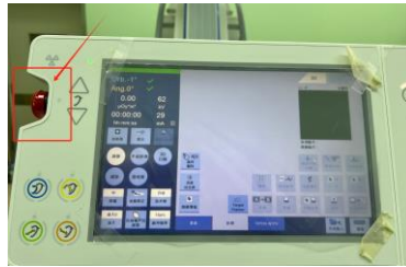
图 3-4 本项目移动式 C 臂机急停按钮
